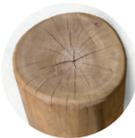
Das Akazienholz, das für die Herstellung der Robinierserie verwendet wird, enthält viele Öle, die das Material sehr gut vor Witterungseinflüssen schützen und es auf natürliche Weise vor Fäulnisprozessen und Schädlingen bewahren. Bei der Beschaffung des Holzes sind wir sicher, dass es aus europäischen Plantagen mit FSC®-Zertifizierung und anderen kontrollierten Quellen stammt, dank derer wir uns im Sinne einer nachhaltigen Entwicklung um die Zukunft kümmern.
